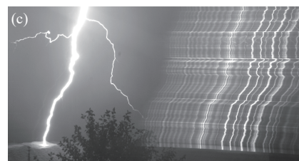
图 3 首次回击不同时刻的原始光谱图。(a) -0.125 ms; (b) 0 ms; (c) 0.125 ms
